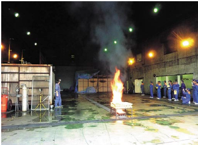
能美防災メヌマ工場(放水型スプリンクラー設備消火実験)
